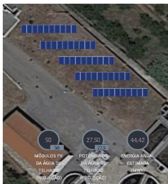
A Instalação fotovoltaica deve garantir um mínimo de 28,50kWp com uma estrutura de suporte
