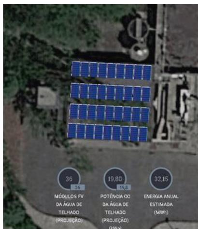
A Instalação fotovoltaica deve garantir um mínimo de 21,66kWp com uma estrutura de suporte com inclinação de 35° e orientação sul, associados a um inversor de com uma potência mínima de 20kW. A instalação deve produzir no mínimo 32.832kWh anuais.
