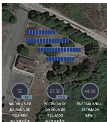
A Instalação fotovoltaica deve garantir um mínimo de 22,80kWp com uma estrutura de suporte com inclinação de 35º e orientação sul, associados a um inversor de com uma potência mínima de 20kW. A instalação deve produzir no mínimo 34.765kWh anuais.
