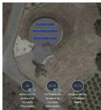
A Instalação fotovoltaica deve garantir um mínimo de 23,94kWp com uma estrutura de suporte com inclinação de 35° e orientação sul, associados a um inversor de com uma potência mínima
