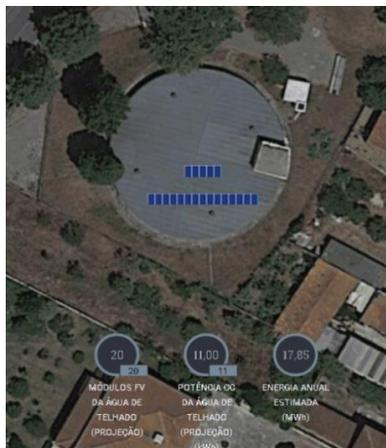
A Instalação fotovoltaica deve garantir um mínimo de 17,10kWp com uma estrutura de suporte com uma inclinação de 35° orientação sul, associados a um inversor de com uma potência mínima de 15kW. A
