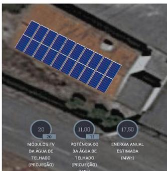
A Instalação fotovoltaica deve garantir um mínimo de 11,40kWp com uma estrutura de suporte para telhado inclinado, associados a um inversor com uma potência mínima de 10kW. A instalação deve produzir no mínimo 14.693kWh anuais.
