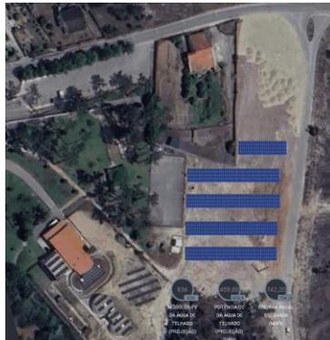
A Instalação fotovoltaica deve garantir um mínimo de 451kWp com uma estrutura de suporte com inclinação de 35° e orientação sul, associados a vários inversores de com uma potência mínima total de 410kW. A instalação deve produzir no mínimo 651.259kWh anuais. Neste local será passar os condutores DC por condutas existentes até ao inversor colocado na sala técnica.
