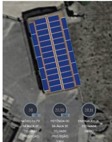
A Instalação fotovoltaica deve garantir um mínimo de 20,52kWp com uma estrutura de suporte para telhado inclinado, associados a um inversor com duas strings (nascente poente) com uma potência mínima de 20kW. A instalação deve produzir no mínimo 28.541kWh anuais.
