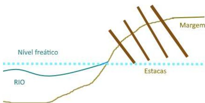
**Ilustração 11 – Esquema demonstrativo da aplicação de estacaria viva**
