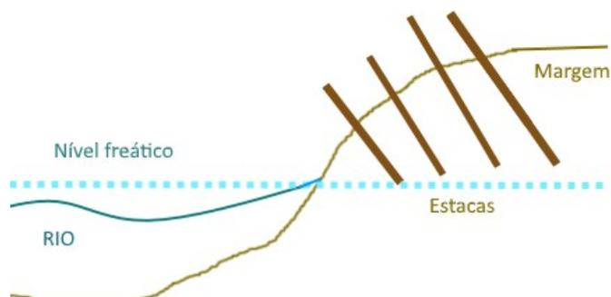
Figura 2 – Esquema demonstrativo da aplicação de estacaria viva
